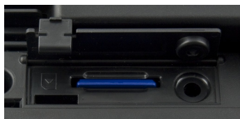
Durch den eingebauten SD-Kartenslot ist der Datenaustausch für Berichte, Programmierung, Screenshots, Updates und Grafiken problemlos möglich
